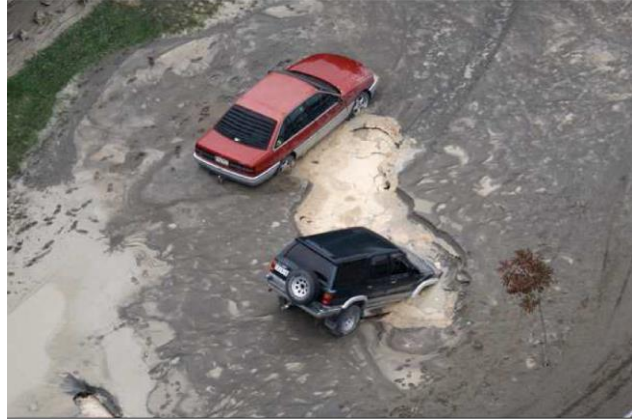
Şekil 4: Sıvılaştıran toprağın “dalgaları” (solda) ve ciddi biçimde sıvılaştıran alan (sağda). Yeni Zelanda Christchurch depreminden fotoğraflar (M6.3, 21-2-2011) kaynak: http://www.nzherald.co.nz .
