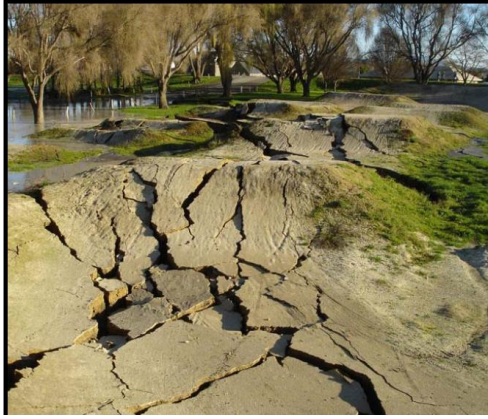
Şekil 4: Sıvılaştıran toprağın “dalgaları” (solda) ve ciddi biçimde sıvılaştıran alan (sağda). Yeni Zelanda Christchurch depreminden fotoğraflar (M6.3, 21-2-2011) kaynak: http://www.nzherald.co.nz .
