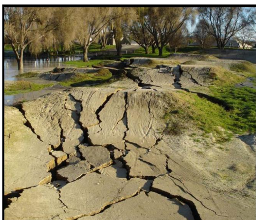
Σχήμα 4: “Κύματα” ρευστοποιημένου εδάφους (αριστερά) και σημαντικά ρευστοποιημένη περιοχή (δεξιά). Φωτογραφίες από τον σεισμό του Christchurch στη Νέα Ζηλανδία (M6.3, 21-2-201), 1πηγή: http://www.nzherald.co.nz .
