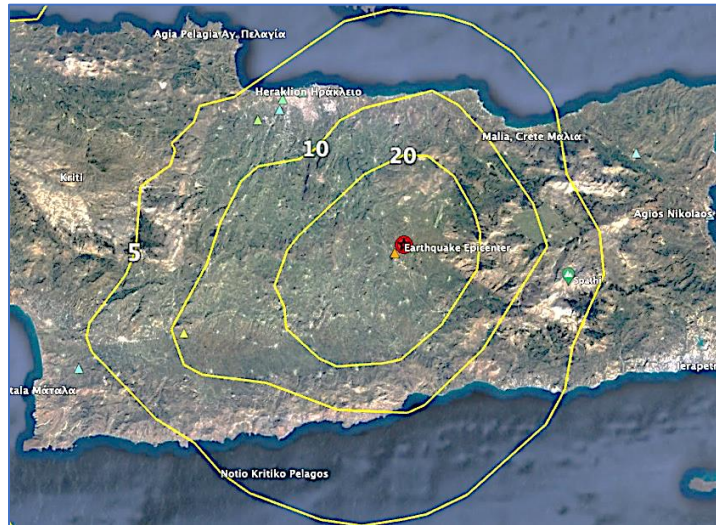
Şekil 2. Yer ivmesi açısından 6.0 Büyüklüğündeki Arkalochori (Girit) depremine ait Sarsıntı Haritası (maksimum yer ivmesi eş dağılım eğrileri [%g], g: yerçekim ivmesi). Üçgen semboller yer hareketinin kaydedildiği ivmeölçer istasyonlarını tanımlamaktadır ( http://shakemaps.itsak.gr ).
