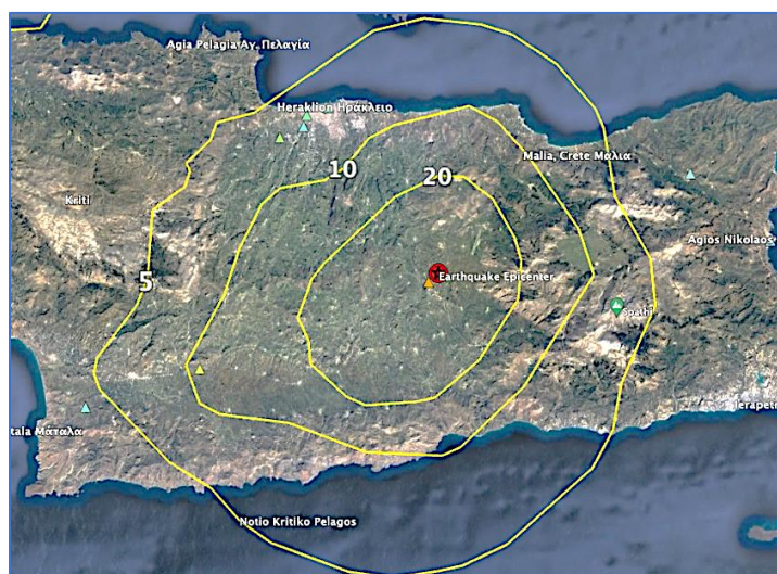
Figură 2 Harta mișcării seismice a cutremurului M6.0 din Arkalochori, Creta, în termeni de accelerație maximă a solului (izocontururi de [%g], g: accelerația gravitației). Triunghiurile indică stațiile de accelerometru care au înregistrat mișcarea solului ( http://shakemaps.itsak.gr ).
