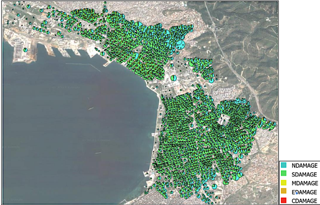
Σχήμα 8. Εκτιμώμενη χωρική κατανομή των επιπέδων βλάβης των κτιρίων στα οικοδομικά τετράγωνα της πόλης της Θεσσαλονίκης για το σενάριο του σεισμού της 20/6/1978 (M6.5), 20km ανατολικά της πόλης.
